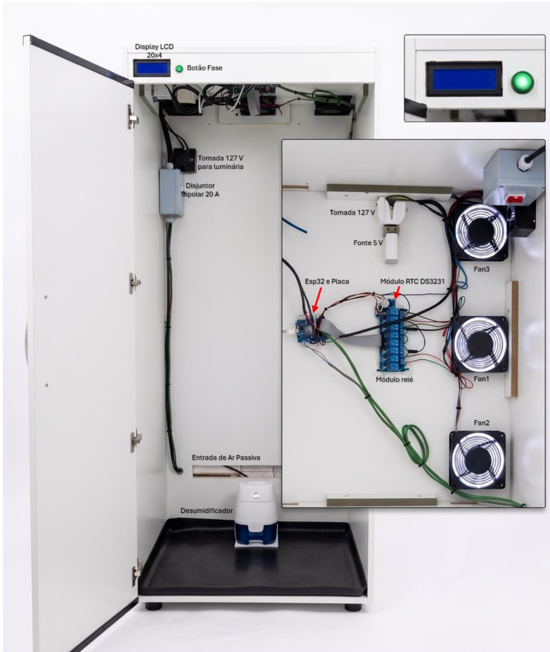
Figura 30 - Protótipo finalizado do sistema de automação microclimática durante o período de testes laboratoriais.
