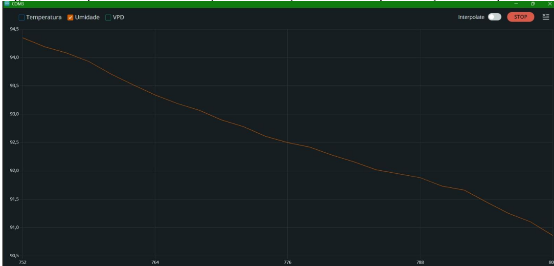
Figura 36 - Resposta do sistema à redução e estabilização da umidade após a atuação dos componentes.
