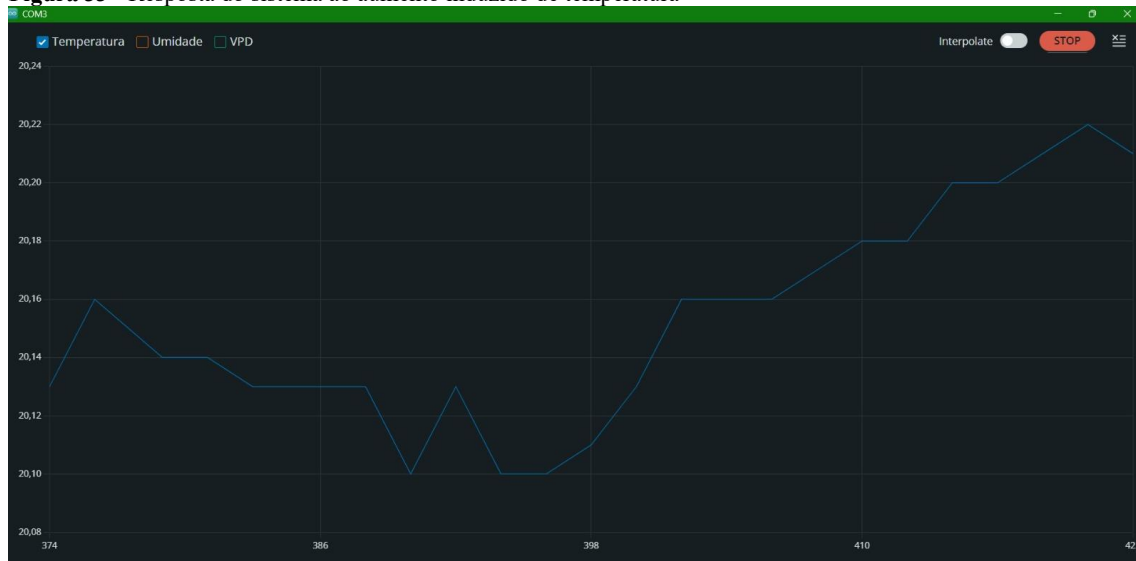
Figura 33 - Resposta do sistema ao aumento induzido de temperatura
