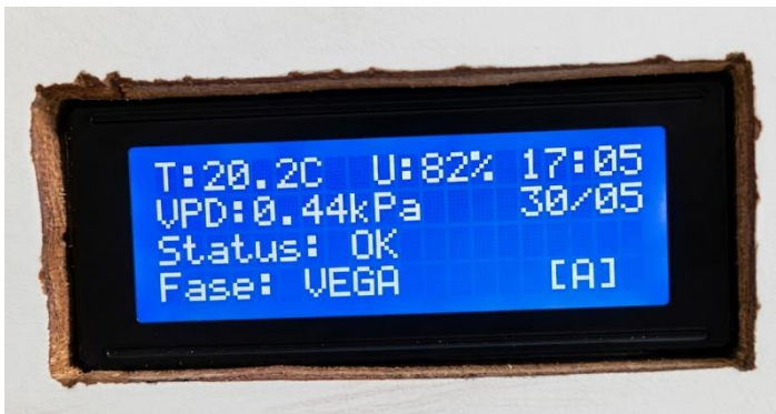
Figura 31 - Interface física em display LCD exibindo os parâmetros locais de controle na fase vegetativa.
