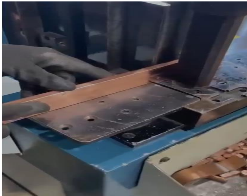
Figura 8 - Barra Posicionada na Matriz de Dobra
