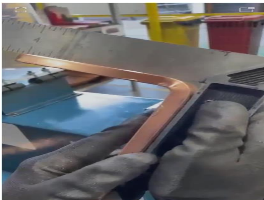
Figura 9 - Qualidade Angular de 90° do Barramento
