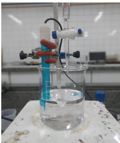
Figura 29 – Sistema de comparação de sensores de pH (Sensor bancada).
