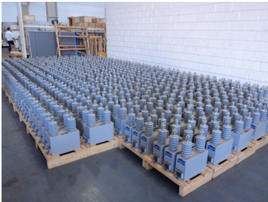
Figura 12 - Capacitores de Potência prontos para embarque
