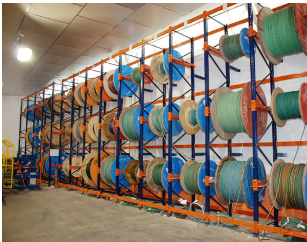
Figura 19 – Estrutura Porta Bobinas
