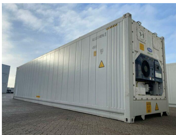
Figura 3: Modelo de contêiner reefer utilizado no transporte internacional de cargas refrigeradas.
