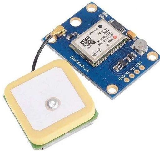
Imagem 9 - Módulo GPS GY-NEO6MV2 com Antena
