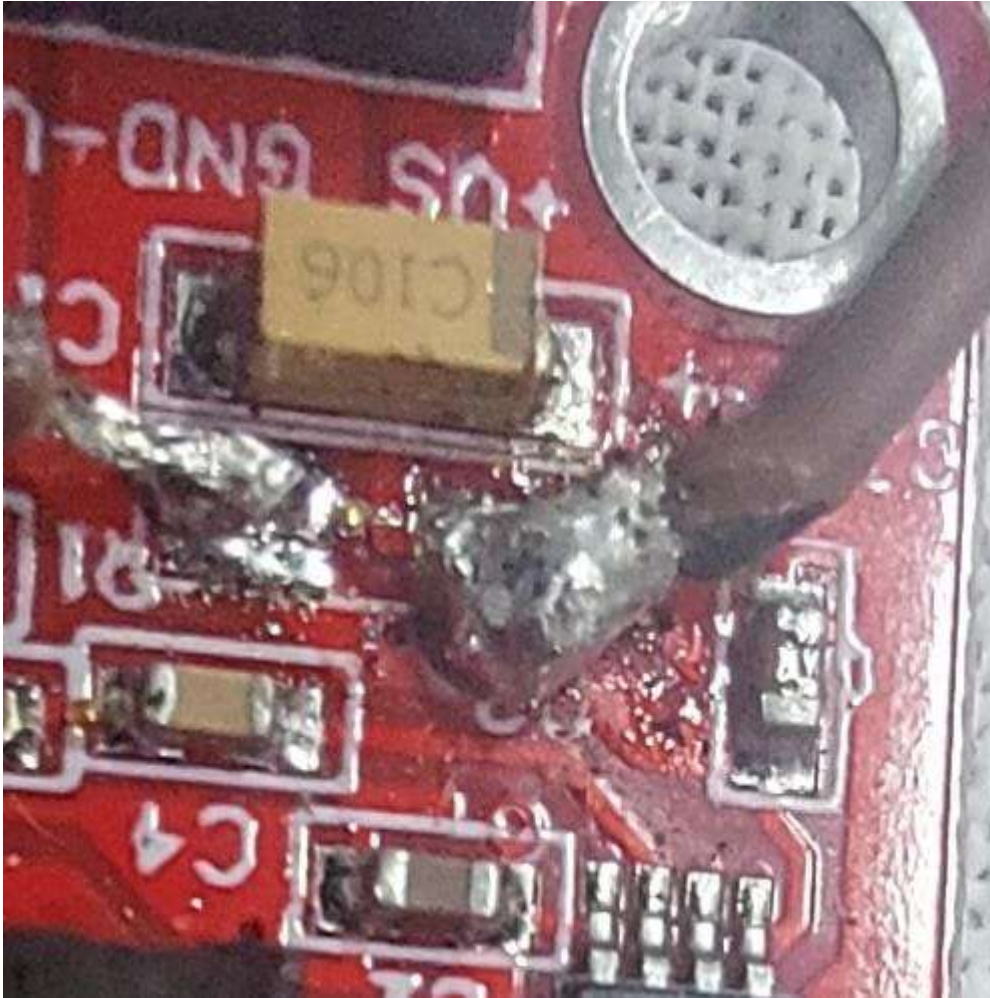
Figura 27 – Foto da tentativa de trocar o capacitor queimado do sensor EMG. – Foto dos autores - 29/9/2025.
