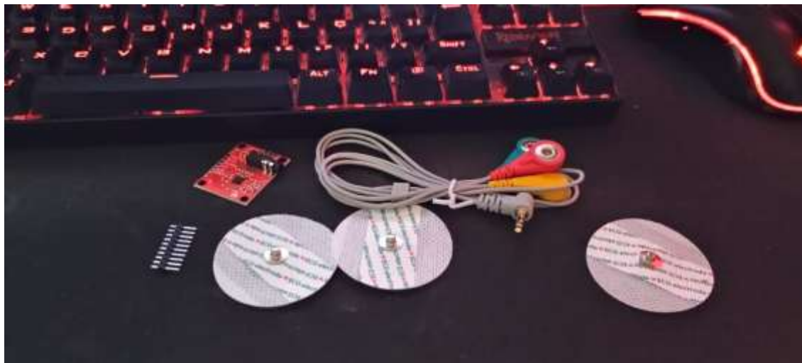
Figura 28 – Foto do sensor ECG confundido com um sensor EMG. – Foto dos autores - 11/8/2025.
