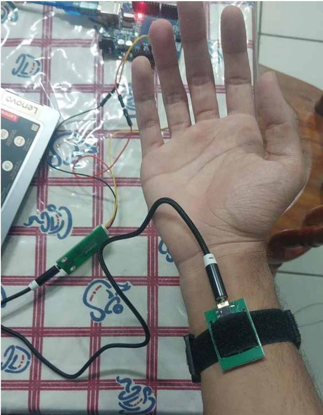
Figura 32 – Foto do sensor EMG da Shichiray em teste. – Foto dos autores - 17/9/2025.
