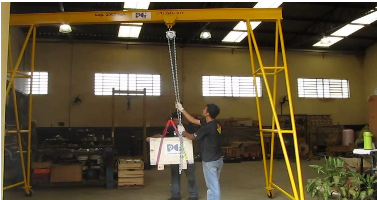
Figura 8 – içamento utilizando talha com corrente manual
