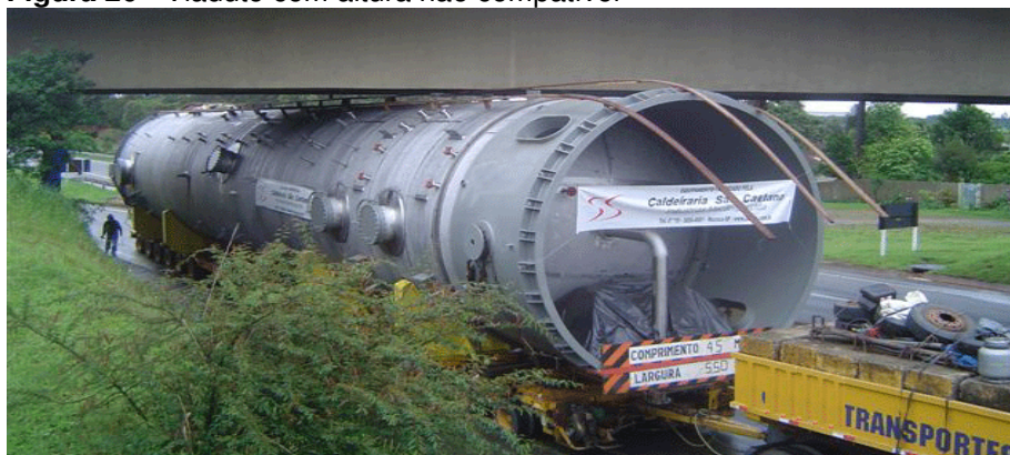
Figura 20 - Viaduto com altura não compatível
