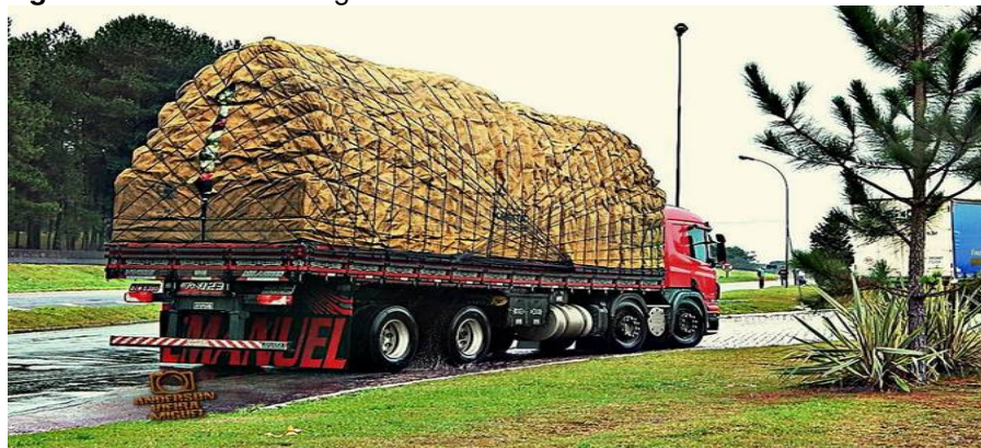
Figura 7- Excesso de carga
