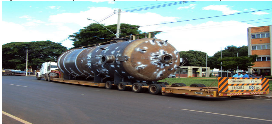
Figura 27 - Carreta prancha largartixa transportando vaso de pressão
