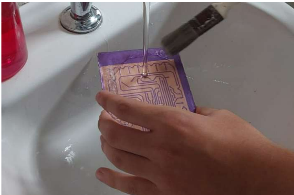
Figura 26. Remoção do dry film não pertencente às trilhas
