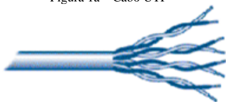
Figura 1a – Cabo UTP
