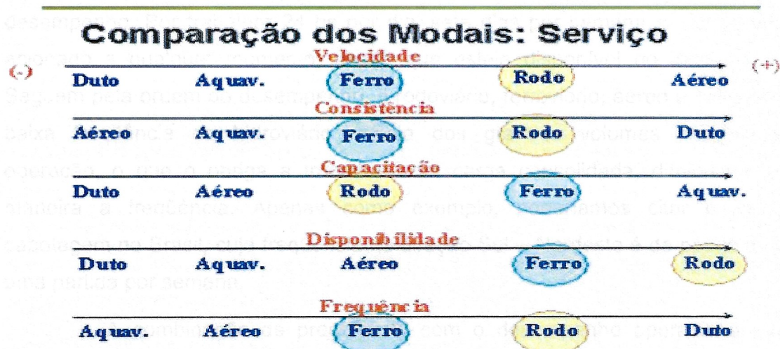
Figura 2: Comparação dos modais em termos das dimensões de serviço
