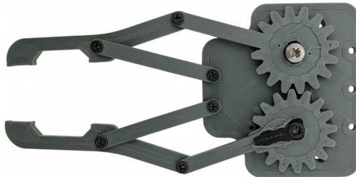
Figura 16 – Parte de cima da garra, onde toda articulação é feita por parafusos
