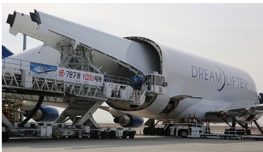
Figura 9: Dreamlifter com sua porta de carga operante.
