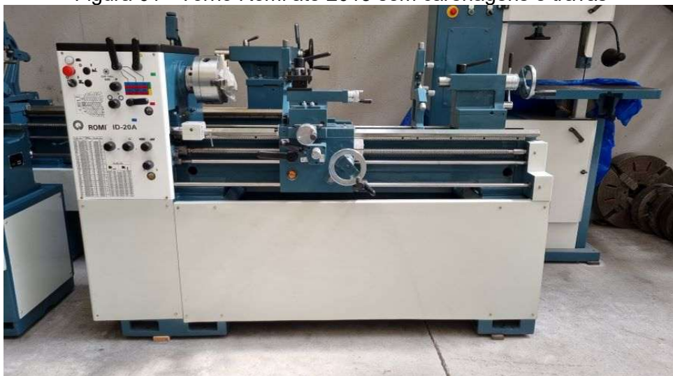
Figura 01 - Torno Romi até 2013 sem carenagens e travas
