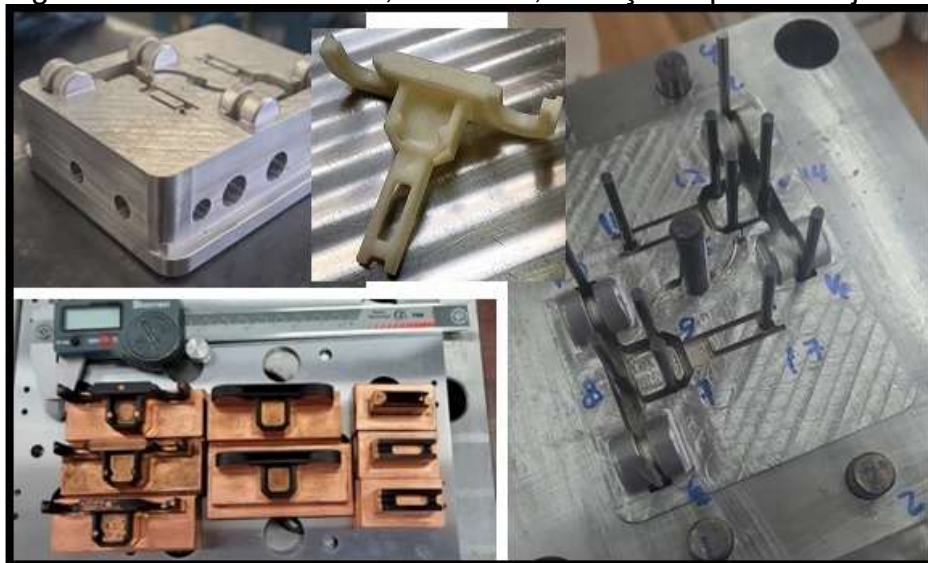
Figura 13 – Molde usinado, eletrodos, extração e produto injetado
