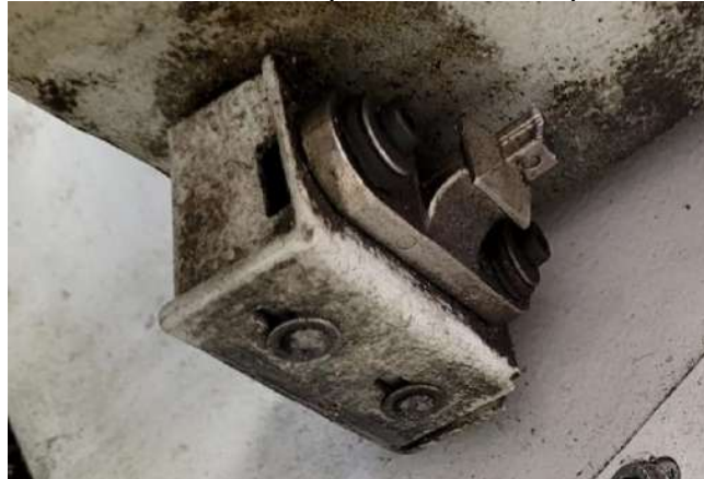
Figura 09 - Extremidade quebrada sob a placa do torno
