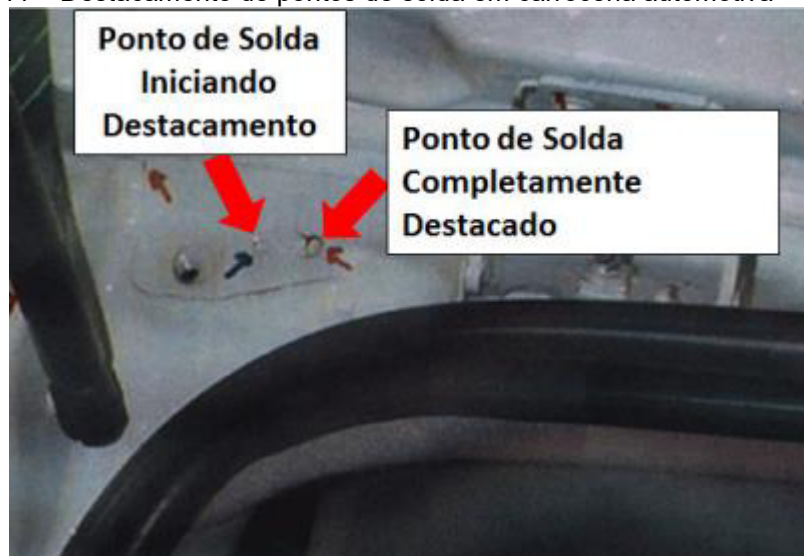
Figura 11 – Destacamento de pontos de solda em carroceria automotiva
