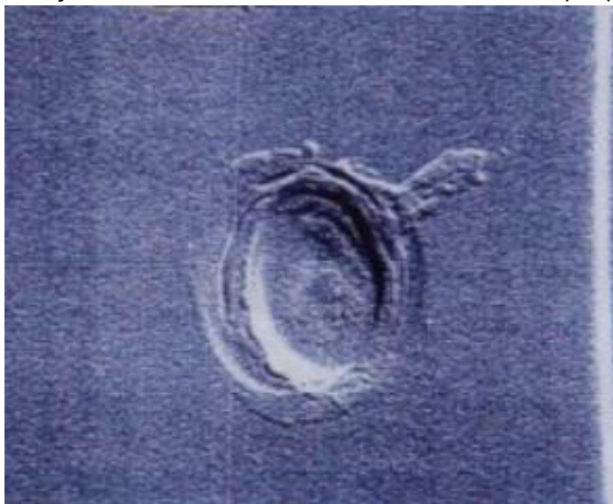
Figura 12 – Deformação e instabilidade térmica resultantes de solda por pontos defeituosa
