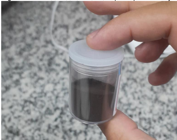
Figura 7 – BaZr 0.5 Ce 0.3 Y 0.1 Yb 0.1 O 3-δ após a pré-calcinação
