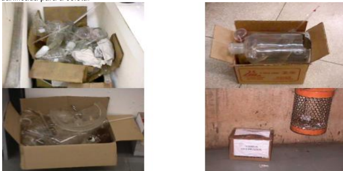
Figura 14 – Maneira inadequada de embalar, identificar e armazenar a vidraria de laboratório danificada para a coleta.
