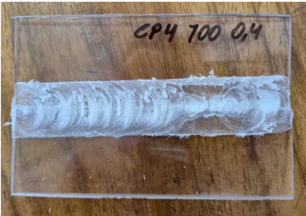
Figura 14 CP 4 condições: profundidade de 04mm, velocidade da ferramenta de 700 RPM e avanço de 45mm/min.
