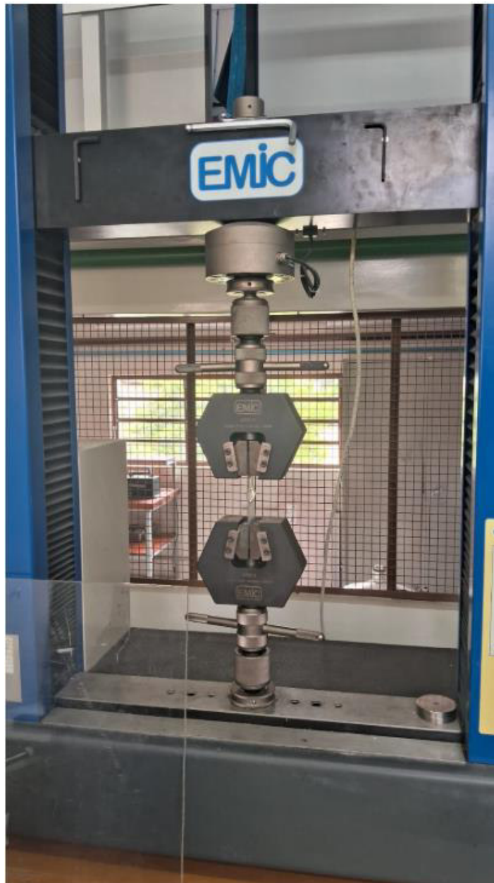
Figura 10 Máquina de tração Marca UMIC Modelo GR012 capacidade Máxima de 100kN
