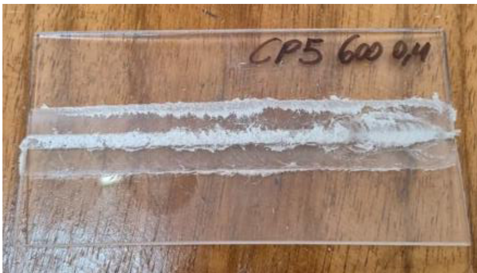
Figura 15 CP 5 condições: profundidade de 04mm, velocidade da ferramenta de 600 RPM e avanço de 45mm/min.
