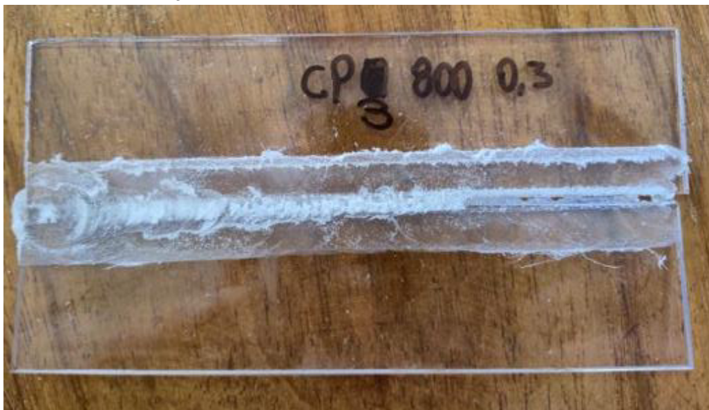
Figura 13 CP 3 condições: profundidade de 03mm, velocidade da ferramenta de 800RPM e avanço de 45mm/min.
