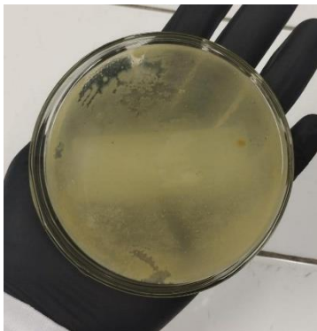
Imagem 3: Placa de Petri infectada após 38 dias. A amostra aplicada foi do terceiro teste, sem conservante. Nota-se o crescimento abundante de microrganismos por toda a placa, devido a falta de componentes antibacterianos que protejam a fórmula da ação de tais.
