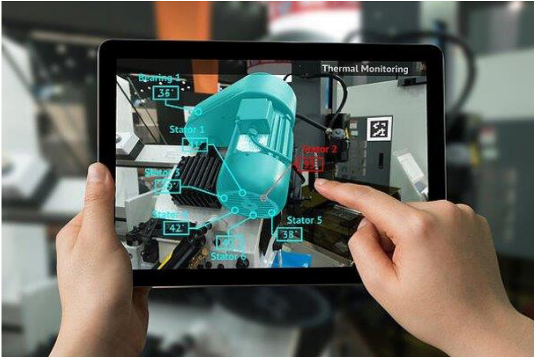
Figura 1 – Aplicação de Realidade Aumentada para monitoramento térmico e manutenção preditiva. https://revistadofrio.com.br/como-a-realidade-aumentada-pode-ajudar-o-hvac-r-a-evoluir/ , 21/09/2023.
