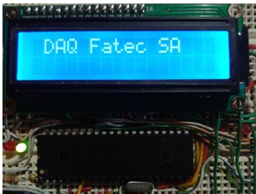
Figura 56 - Resultado da implementação do display LCD no modo 4Bit Mode (Fonte: Os autores).
