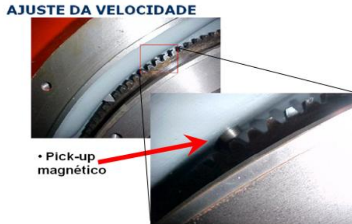
Fig. 8 – Sensor de Relutância Magnética para Controle de Rotação. (Extraído e Adaptado de Monografia Motor Diesel para Geradores Elétricos – Lima, Márcio Roberto de Souza e Silva, Rodrigo Aragão).
