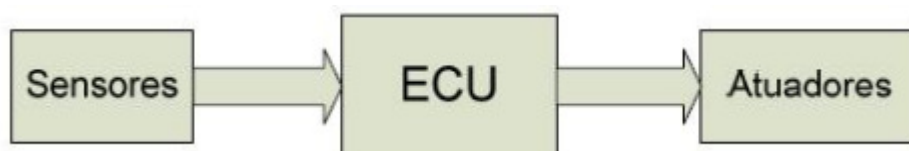
Figura 8 - Três estágios para os controladores de uma ECU [EXTRAÍDO DE BRAGA, 2007].
