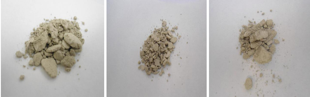
Figura 7 - Aspecto da prata recuperada a partir de 2,000 g de AgCl submetido à reação com zinco por período de 60 minutos
