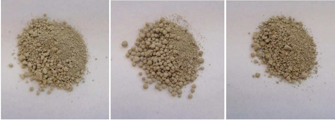
Figura 4 - Aspecto da prata recuperada a partir de 2,000 g de AgCl submetido à reação com glicose por período de 60 minutos.
