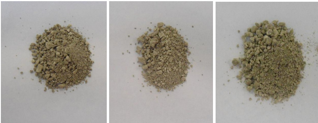
Figura 5 - Aspecto da prata recuperada a partir de 2,000 g de AgCl submetido à reação com sacarose por período de 60 minutos.
