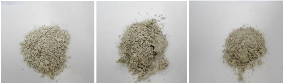
Figura 8 - Aspecto da prata recuperada a partir de 2,000 g de AgCl submetido à reação com cobre por período de 60 minutos.
