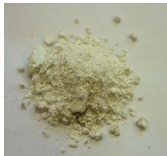
Figura 3 - Aspecto do AgCl precipitado, lavado e seco.
