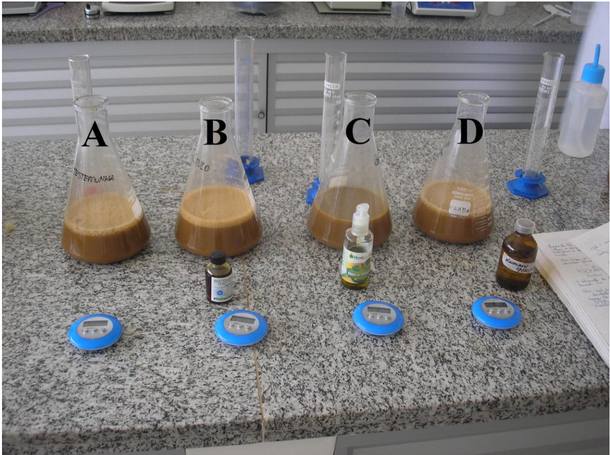
FIGURA 16 – Formação de espuma no tratamento biocidas
