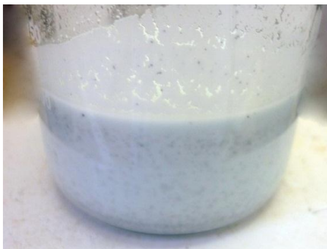
FIGURA 9 - Sólido branco ( ZnSO_4 ), oriundo do tratamento da solução residual com zinco metálico.
