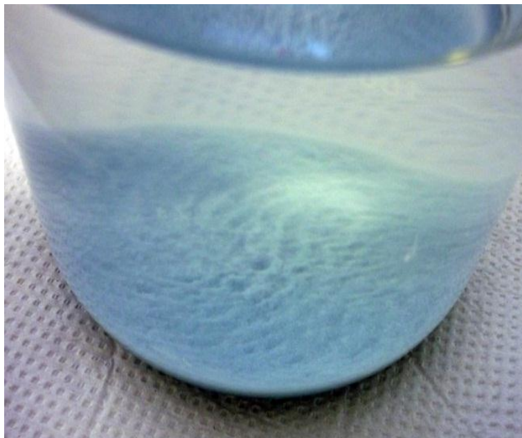
FIGURA 17 - Hidróxido de cromo(III) precipitado a partir do líquido residual do tratamento com cobre metálico
