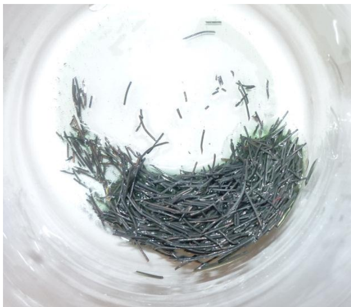
FIGURA 11 - Mercúrio metálico amalgamado ao cobre.
