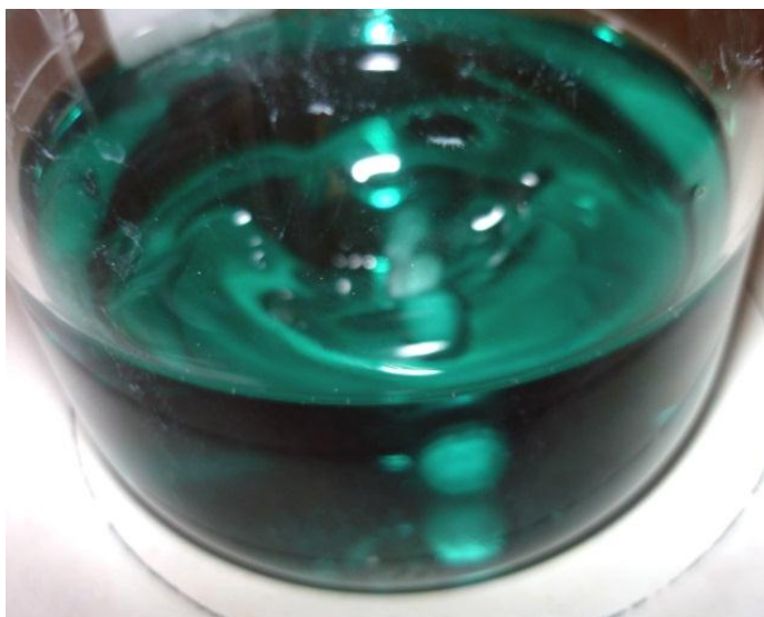
FIGURA 10 - Adição de fios de cobre a solução residual, visando à remoção do mercúrio.
