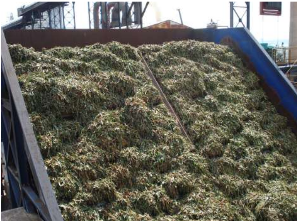
FIGURA 10 – Mesa Alimentadora com sorgo sacarino (DEDINI e NOBLE GROUP, 2012)
