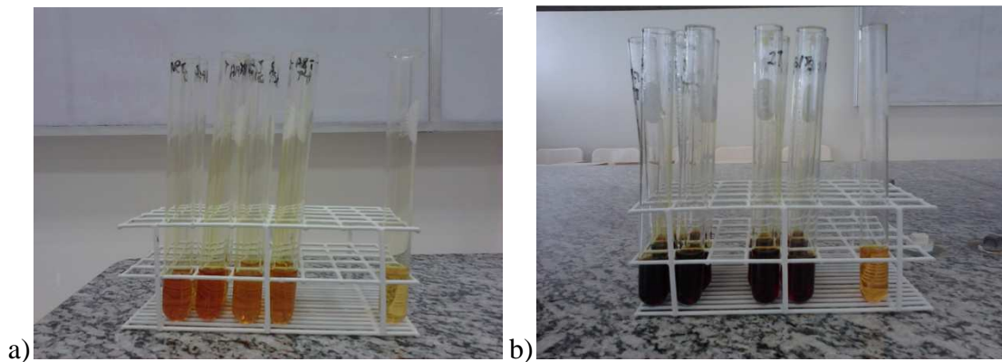
FIGURA 11 - a) tubos de ensaio contendo a solução problema tratada com NaOH e DNS antes do aquecimento; b) tubos de ensaio contendo a solução problema tratada com NaOH e DNS depois do aquecimento.
