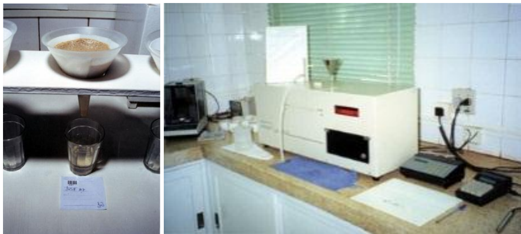
FIGURA 15 – Caldo sendo submetido a filtração no processo de clarificação ao lado de aparelho de polarímetro (CANAOSTE, 2012)
