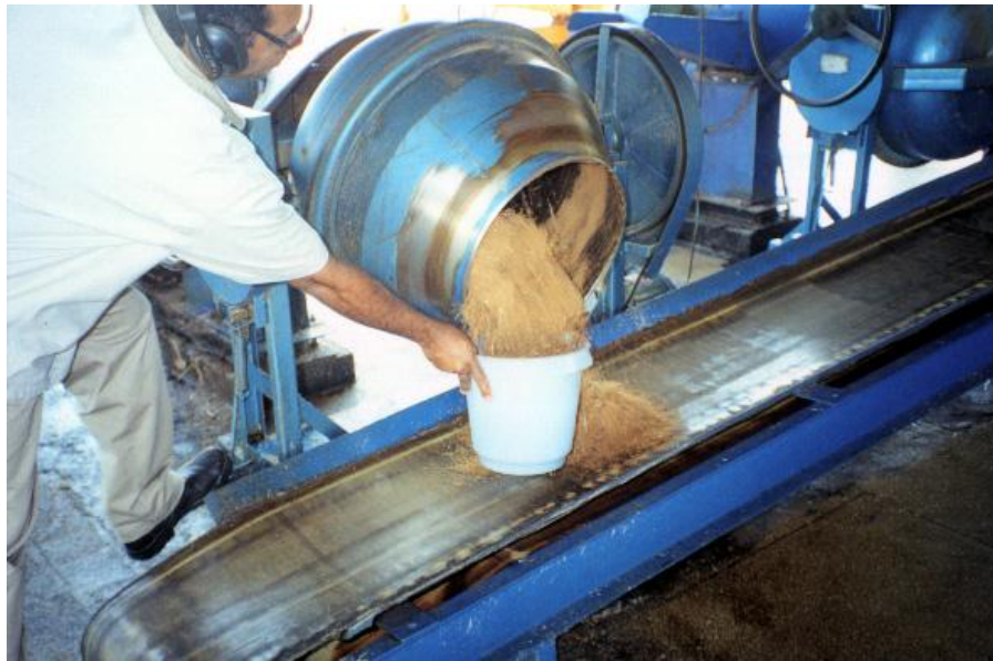
FIGURA 9 – Amostra homogeneizada sendo retirada da betoneira (CANA OESTE, 2012)
