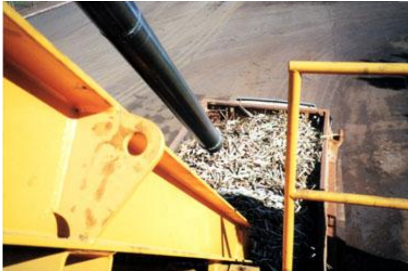
FIGURA 6 – Amostragem de cana feita através de sonda obliqua (CANAOSTE, 2012).
