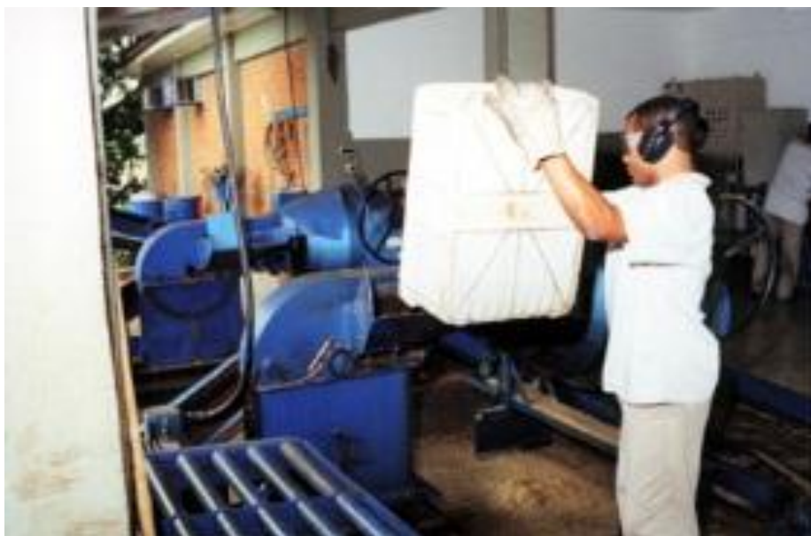
FIGURA 7 – Amostra sendo desintegrada (CANAOSTE, 2012)
