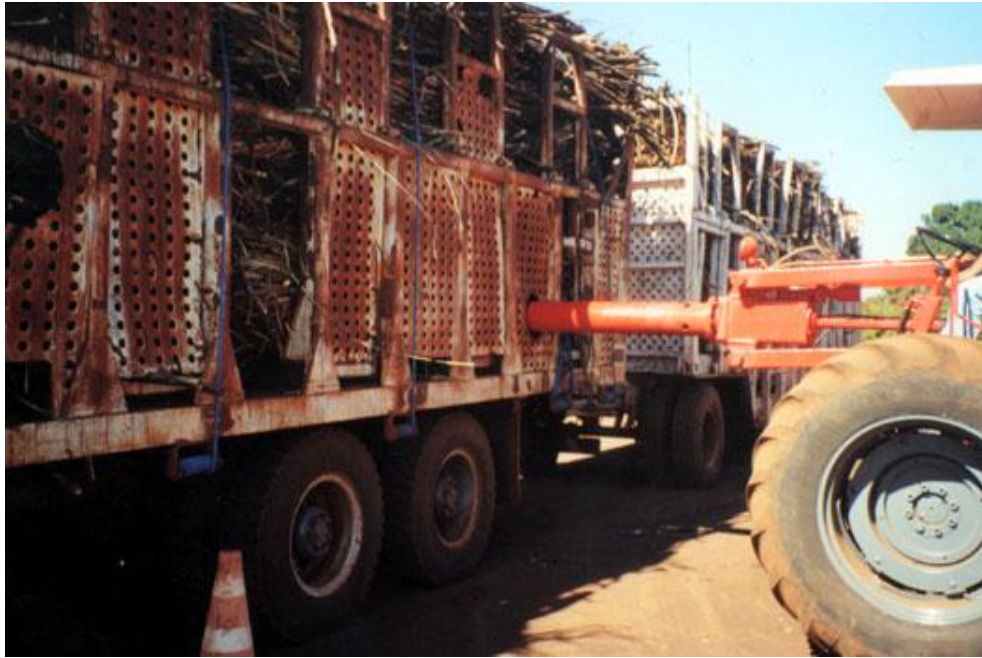
FIGURA 4 – Amostragem de cana feita através de sonda horizontal. (CANAOESTE, 2012)
