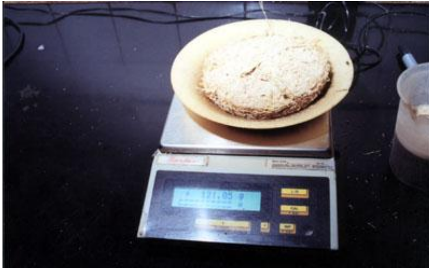
FIGURA 13 - Avaliando o peso do bolo úmido, PBU (CANAESTE, 2012)
