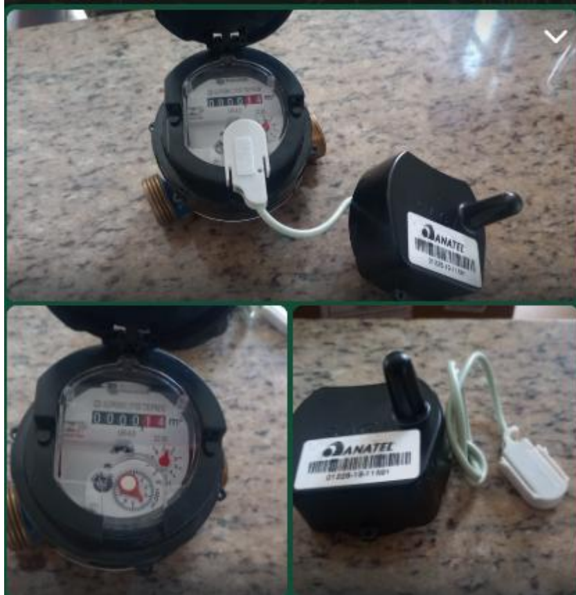
Figura 7: hidrômetro e transmissor.
