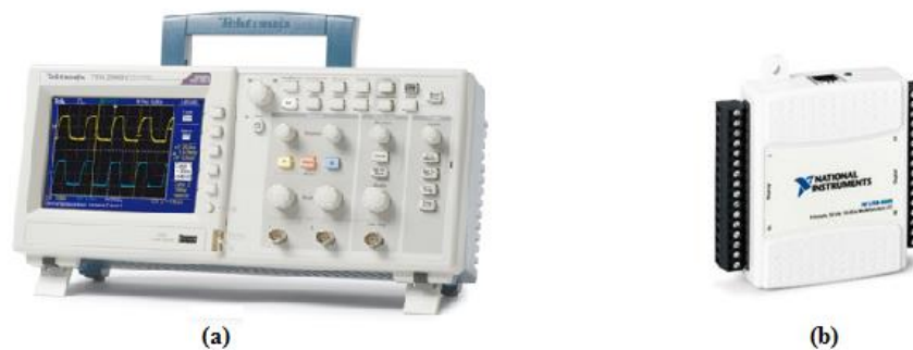
Figura 22 – Ferramentas utilizadas na aquisição de dados: O osciloscópio (a) e a NI DAQ 6009 (b).
