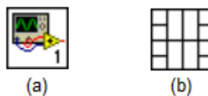
Figura 20 – Ícone de uma VI (a) e painel de conectores de uma VI (b) (Adaptado de NATIONAL INSTRUMENTS, 2007).
