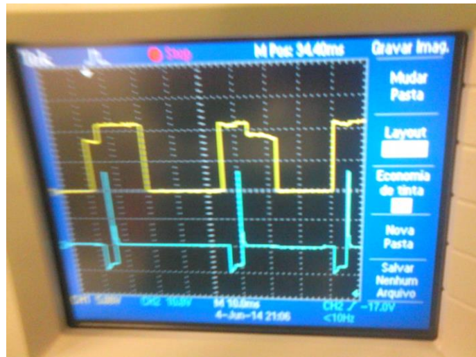
Figura 50 – Tempo de injeção em resposta ao sinal de rotação simulado.
