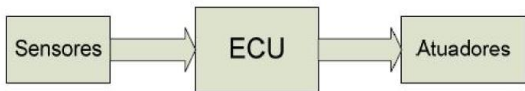
Figura 4 – Estágios do controle realizado pelo sistema de gerenciamento eletrônico (Extraído de Braga, 2007).
