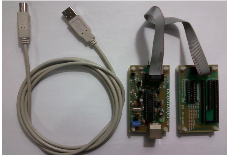
Figura 27 Programador, cabos e placa adaptadora [do autor]
