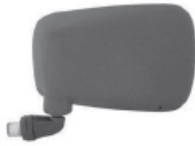
Figura 12 Retrovisor esquerdo VW Fusca ano 1980. Extraído de [4]
