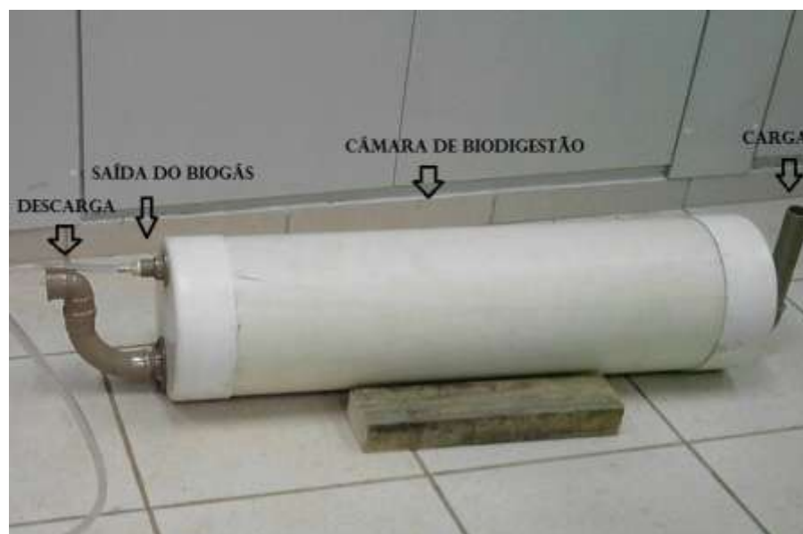
Figura 2: Biodigestor contínuo utilizado.
