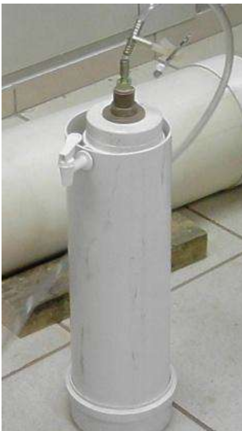
Figura 3: Gasômetro do Biodigestor Contínuo
