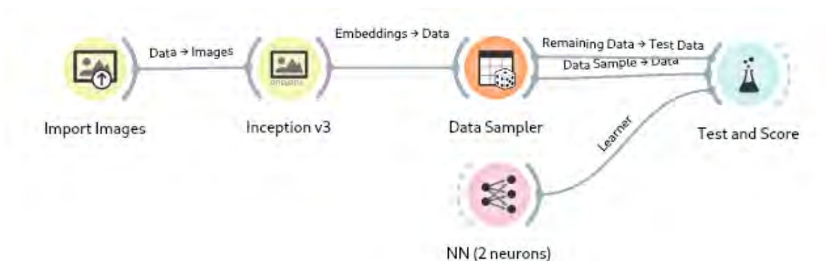
Figura 7 – Workflow desenvolvido para realizar validação cruzada do modelo final utilizando bootstrapping com o estimador .632
