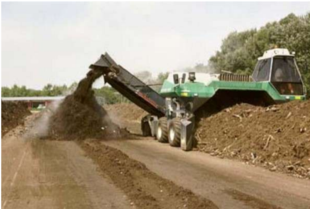
FIGURA 4 - Equipamento utilizado para Revolvimento do Composto (Trator Auto Propelado)
