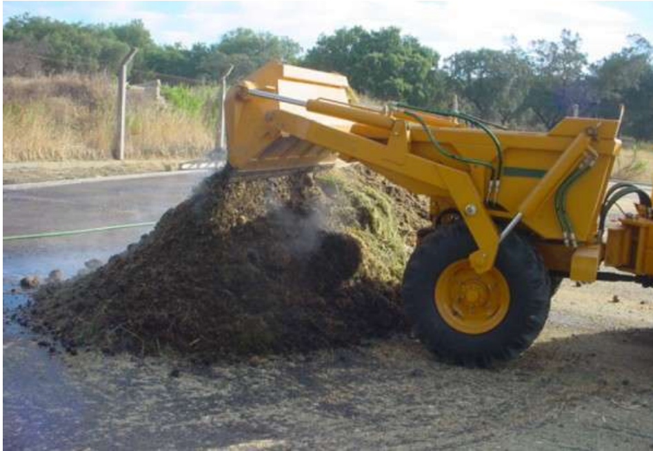
FIGURA 3 - Equipamento utilizado para Revolvimento do Composto (Pá de trator)
