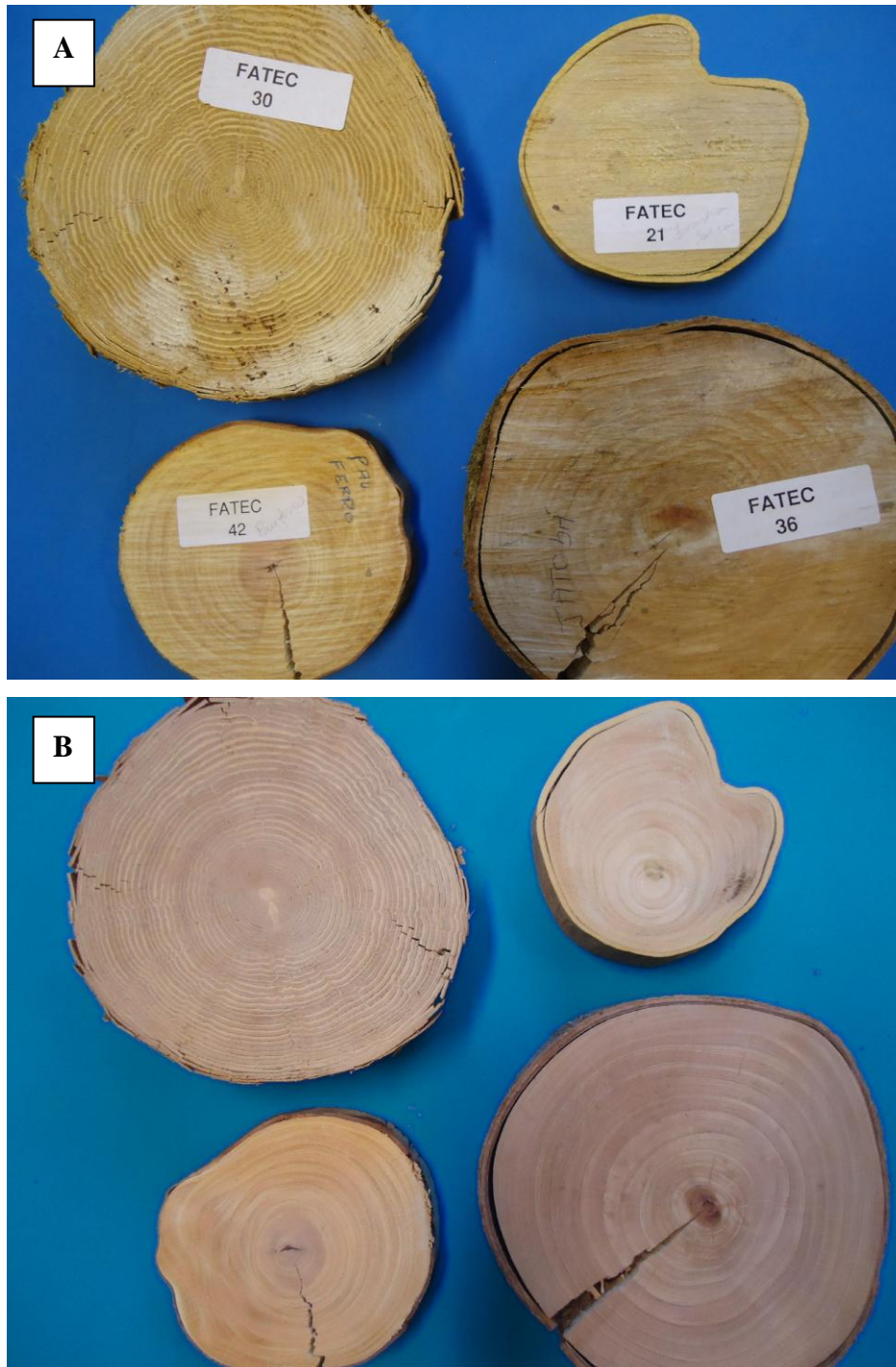
FIGURA 9- Amostras de madeira não trabalhadas (A) e amostras após o polimento (B), (Fatec 30- Gallezia integrifolia (Pau d'alto), Fatec 21- Albizia hasslerii (Farinha Seca), Fatec 42- Caesalpinia férrea (Pau Ferro) e Fatec 36- Hymenaeae courbaril (Jatobá)).
