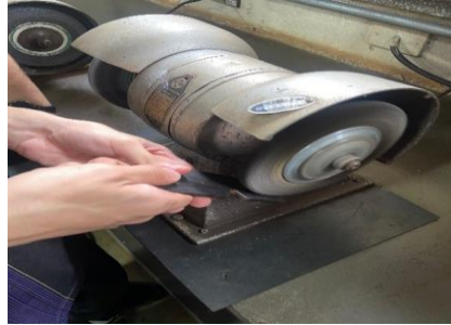
Figura 3 – Remoção de corrosão de elementos.
