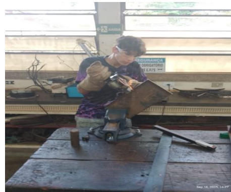
Imagem 3 – Corte das vigas da estrutura na lixadeira com disco de corte
