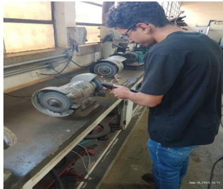
Imagem 5 – Correção de imperfeições das vigas no esmeril
