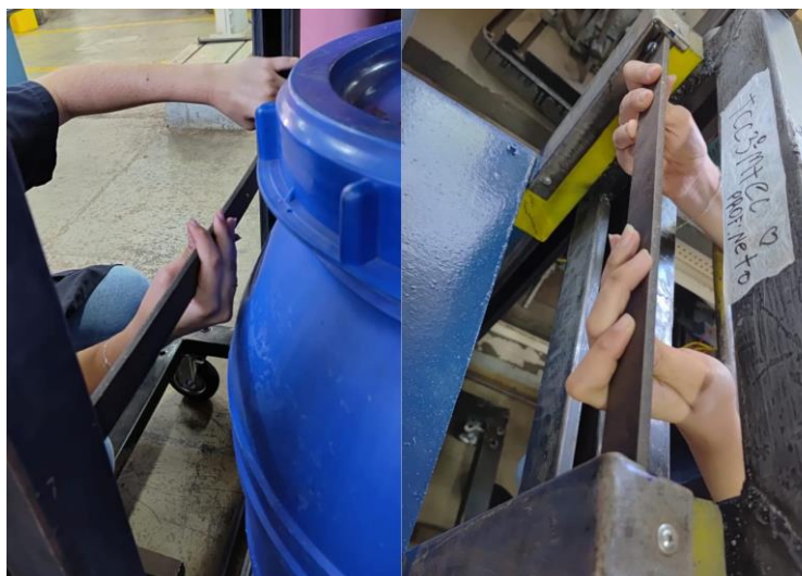
Figura 8 – Passo 9º Medição e corte das barras para fixação das cintas
