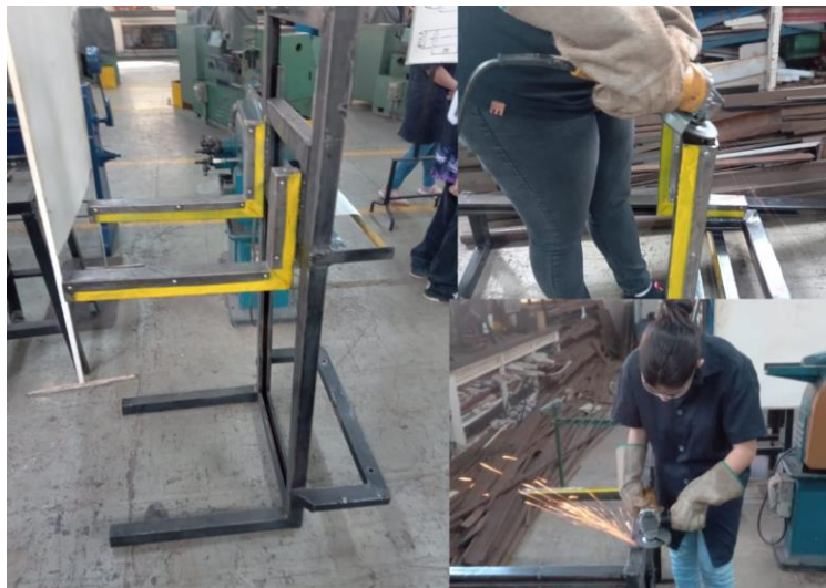
Figura 3 – Passo 4º Limpeza da estrutura, decapagem e retirada de resíduos
