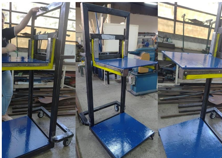
Figura 7 – Passo 8º Fixação das bases e acabamento da pintura
