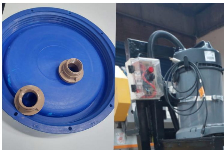
Figura 12 – Passo 13º Instalação das Flanges e do Protótipo Liga/Desliga
