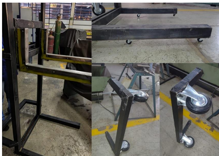
Figura 6 – Passo 7º Soldagem da estrutura para fixação das rodas traseiras e instalação das rodas dianteiras
