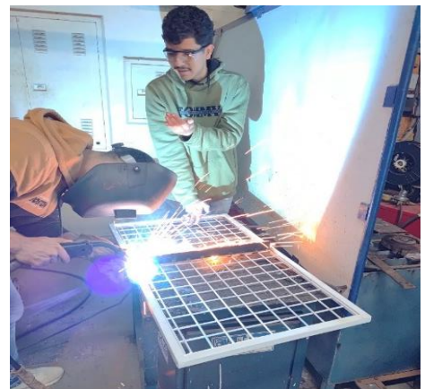
Figura 12: Preparando grade base do protótipo.
