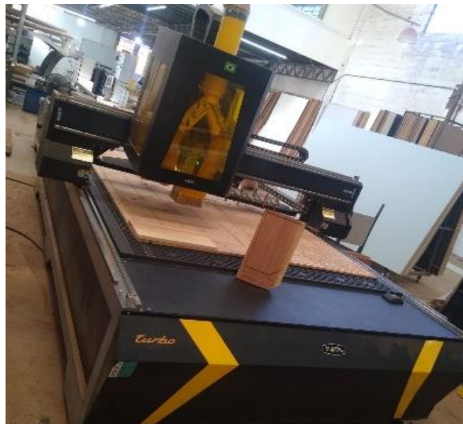
Figura 1: Router CNC utilizada na indústria moveleira.
