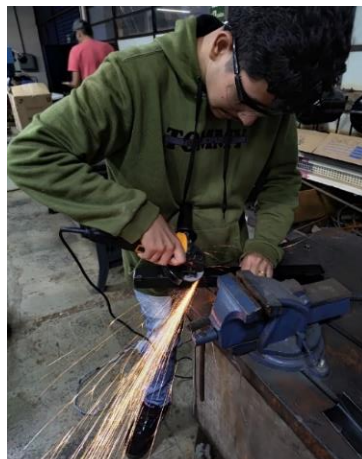
Figura 11: Preparando cantoneira fixação
