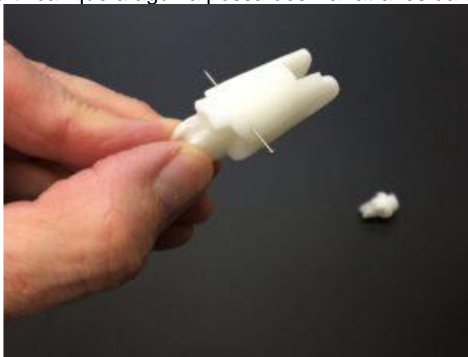
Figura 71 - Certificar que a agulha possa deslizar através da seção do dedo.
