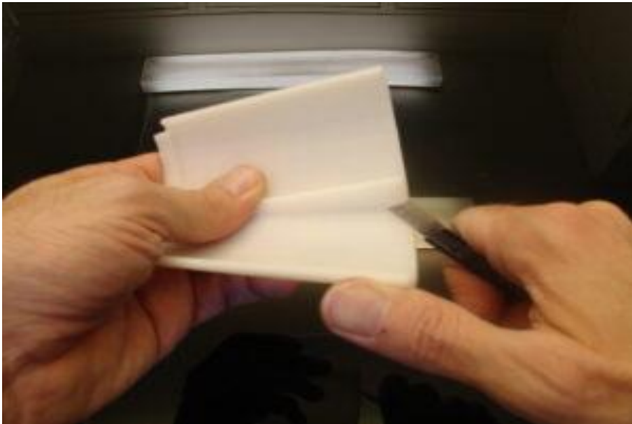
Figura 25 - Remoção dos suportes e aparagem
