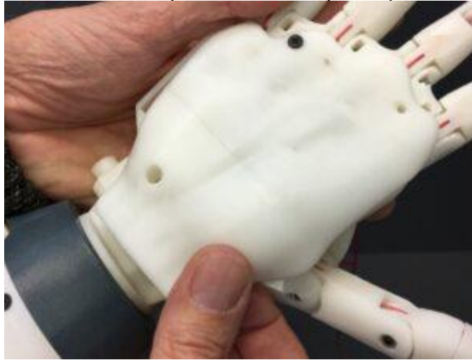
Figura 81 - Colocar e parafusar a tampa da palma da mão
