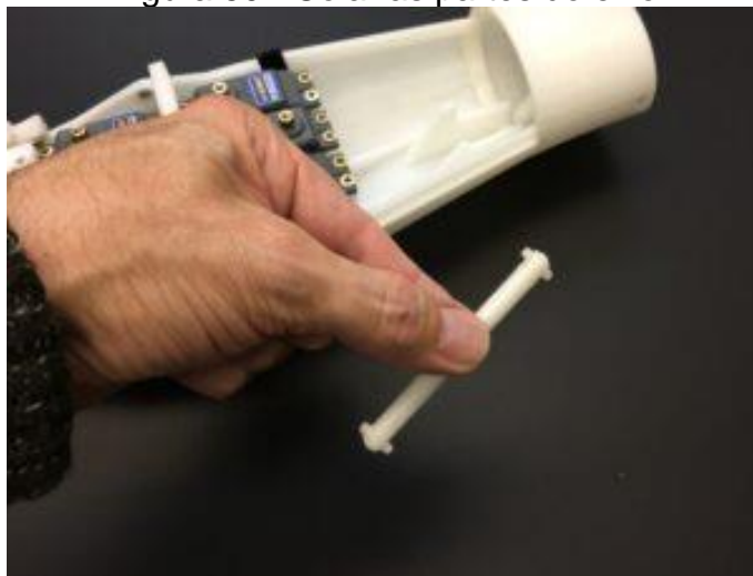
Figura 50 - Colar as partes do eixo
