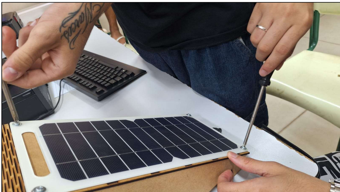
Figura N4 – Fixando a placa solar
