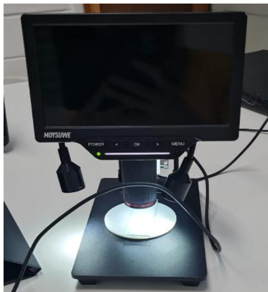
Figura 4 - Imagem do Microscópio digital utilizado para capturar as imagens. Fonte: Google Colab grupo GEAD Agrosense.
