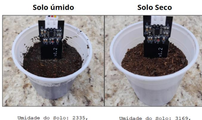
Figura 2 - Testes de detecção da capacitância solo em condições extremas.
