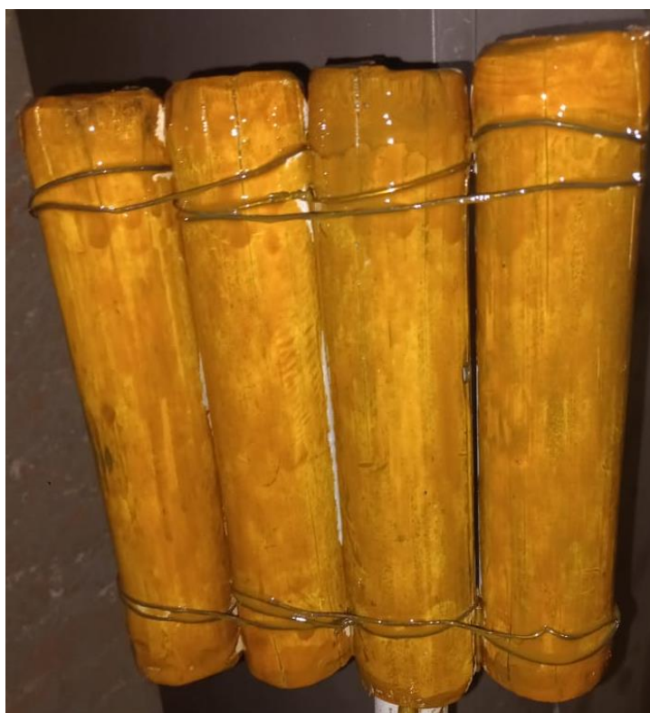
Figura 4 - Processo de envernização do bambu utilizado na estrutura da embarcação
