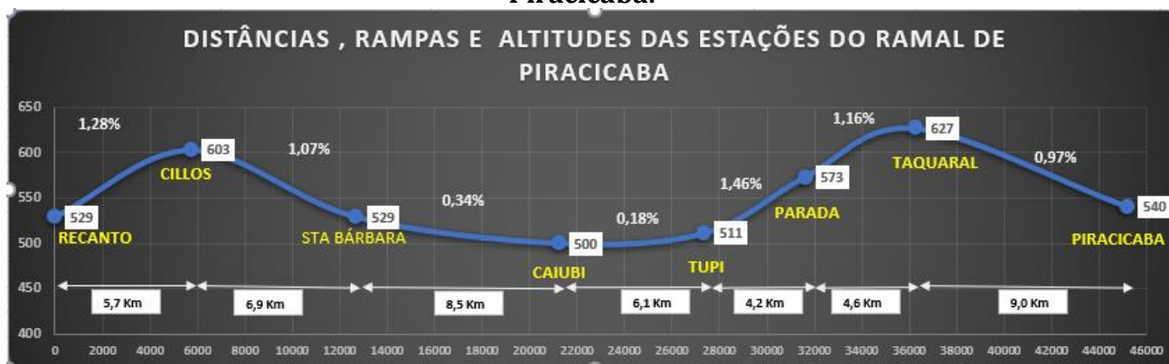
Figura 4 - Gráfico das distâncias, rampas e altitudes das estações do ramal de Piracicaba.
