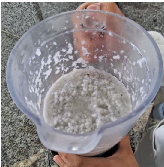
Figura 7 - Trituração das matérias-primas base com auxílio de água
