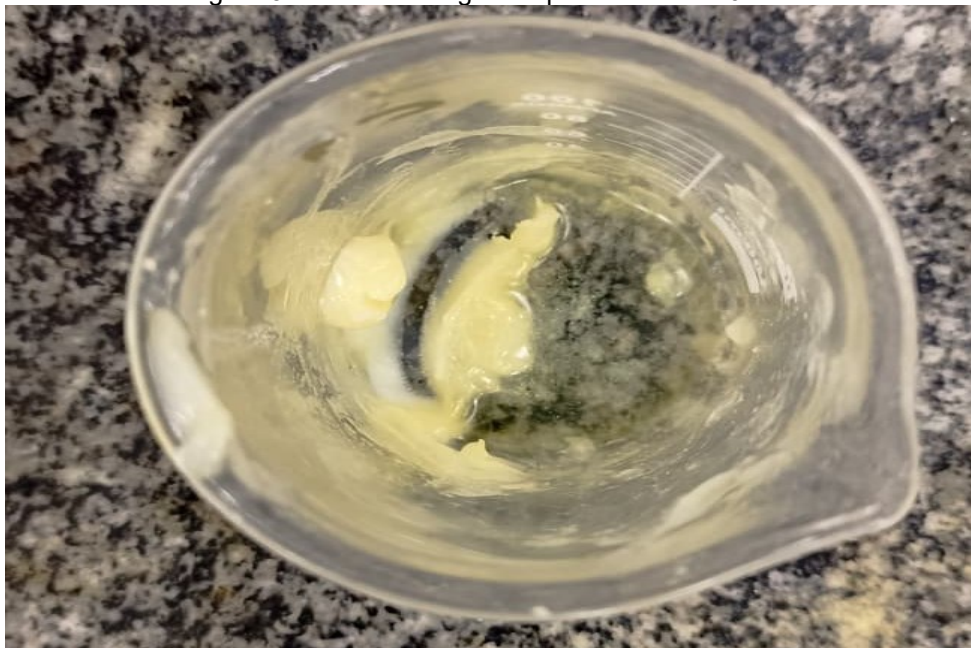
Figura 32: Amostra de graxa após 4 meses e 6 dias
