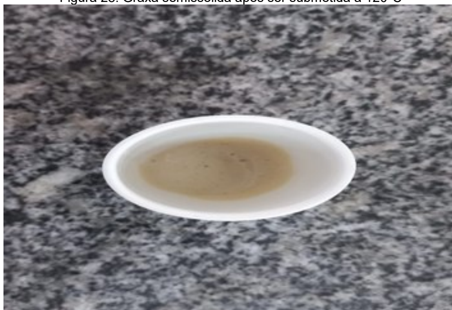
Figura 28: Graxa semissólida após ser submetida a 120°C
