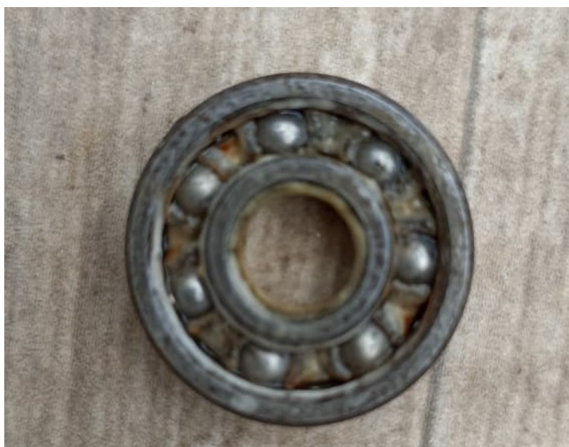
Figura 31: Rolamento com graxa após 3 semanas de exposição
