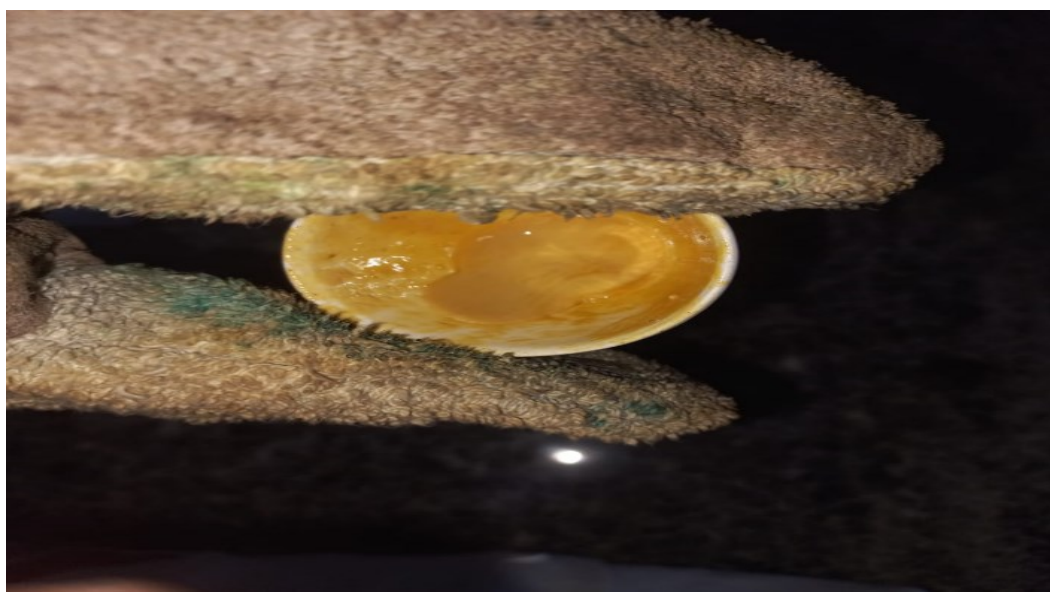
Figura 25: Graxa após ser submetida a 130°C por 2 horas
