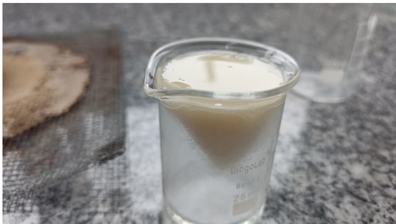
Figura 24: Graxa em um papel filtro para separação de glicerina
