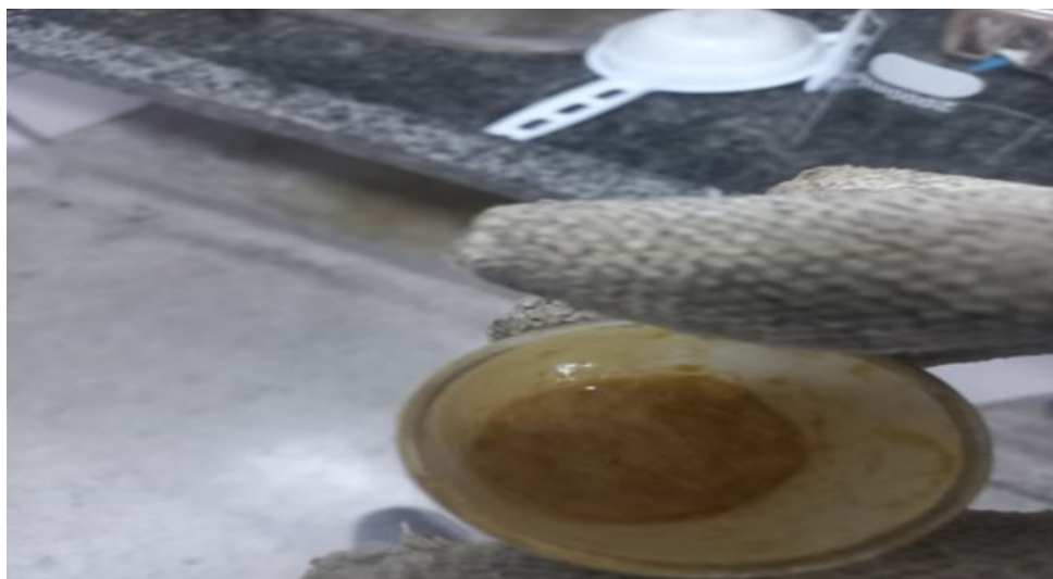
Figura 26: Amostra de graxa após exposição de 135°C
