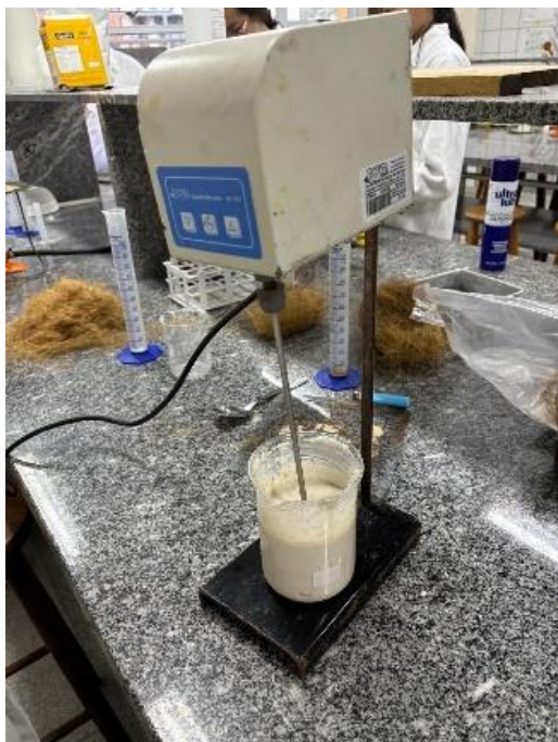
Figura 31 - Foto do processo de mistura do ligante com o agitador mecânico.
