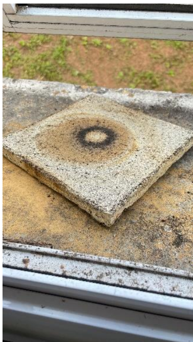
Figura 20 - Foto da placa após o teste de chamas.
