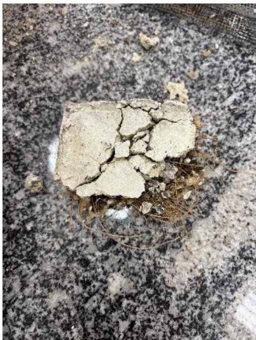
Figura 24 - Foto do pedaço da placa para teste de umidade no solo.
